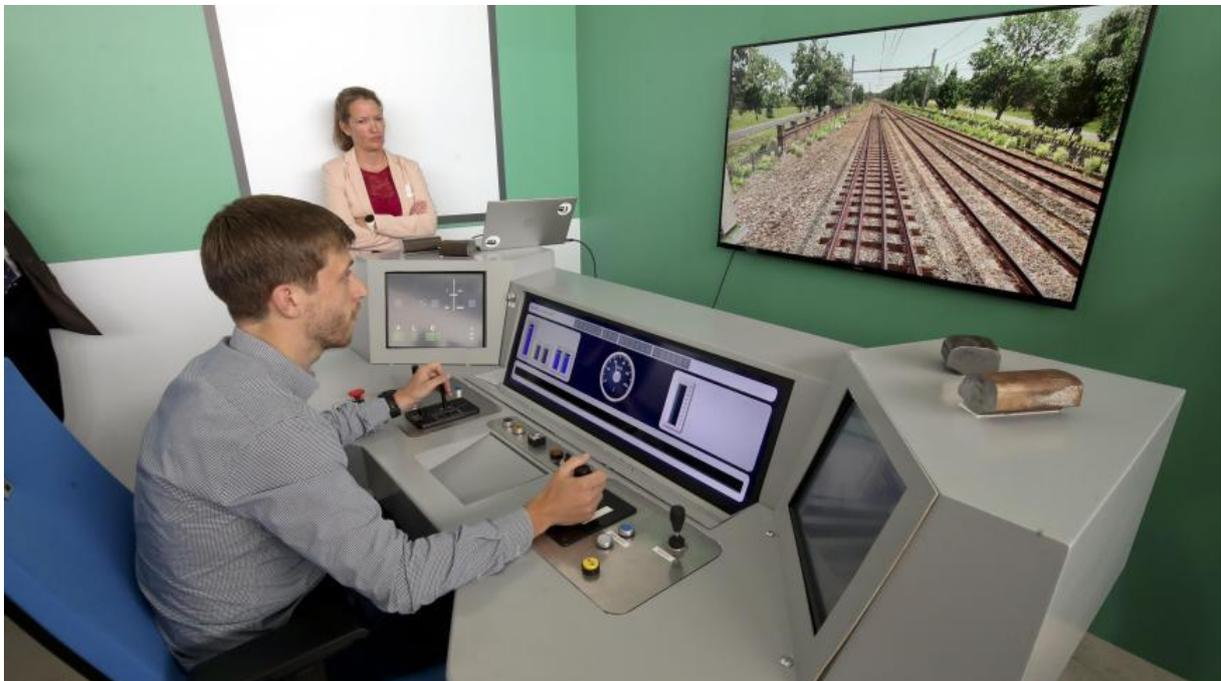
Le TC Rail permet de conduire à distance une locomotive, sans conducteur dans la cabine, mais avec un niveau de sécurité équivalent. - PHOTO SAMI BELLOUMI
